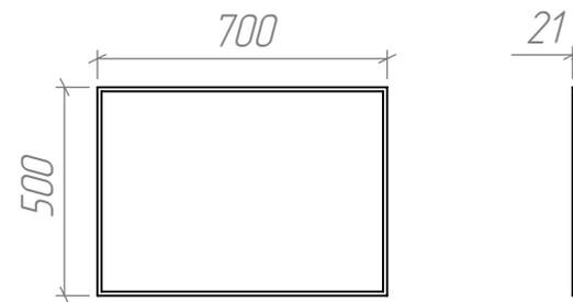
*Габаритные размеры модуля (ШxВxГ):*
