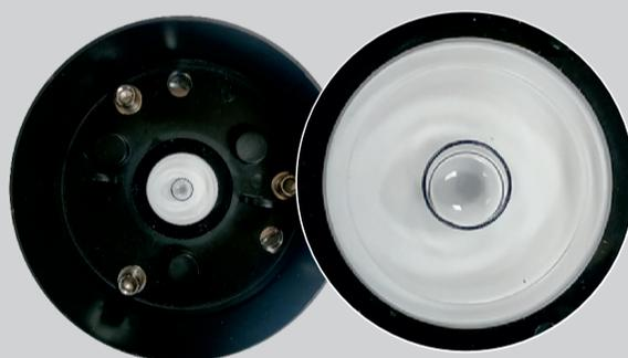
4. После того, как убедились, что основание стоит ровно, шестигранником откручиваем винты. И снимаем черную пластиковую пластину вместе с уровнем.
