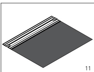
Выполните заливку выравнивающей стяжки (уклон в сторону желоба 1-2%)
