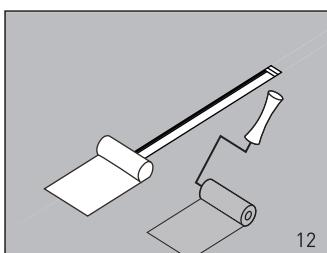
Наклейте рулонную гидроизоляцию и нанесите жидкую гидроизоляцию в 2 слоя на всю поверхность пола, с заходом на стены
