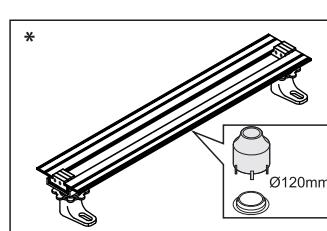
\* При монтаже желоба с вертикальным сифоном разметить место установки и просверлить сквозное отверстие диаметром 120 мм.
