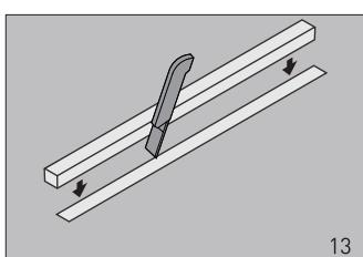
Прорежьте ножом гидроизоляцию по периметру канала желоба. Установите монтажную заглушку.
