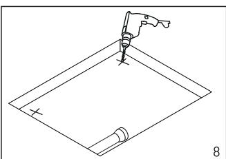
Просверлите отверстия в местах крепления ножек к полу
