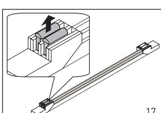
С помощью комплекта регулировки, выровняйте высоту фиксаторов решетки относительно финишного покрытия.
