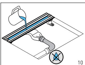
Подсоедините сифон к канализации. Убедитесь в отсутствии протечек в местах соединений, залив воду в корпус желоба.
