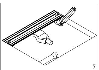
Установите желоб в нишу. Отметьте места крепления ножек к бетонному основанию
