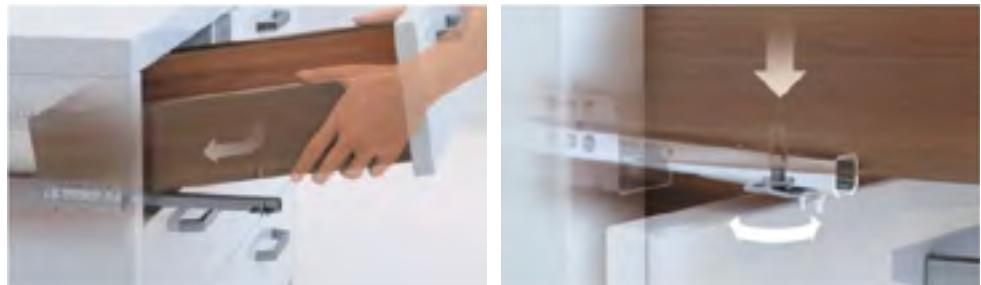
Выдвижной ящик фиксируется благодаря установочным цапфам, а точная высота настраивается с помощью регулировочного колесика.
