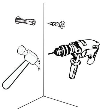
**ВНИМАНИЕ!** В комплектацию входит дюбель, предназначенный только для бетонных и кирпичных стен. Для гипсокартонной стены дюбеля подобрать самостоятельно, а так же изготовить усиленный каркас для правильного распределения нагрузки тумбы
