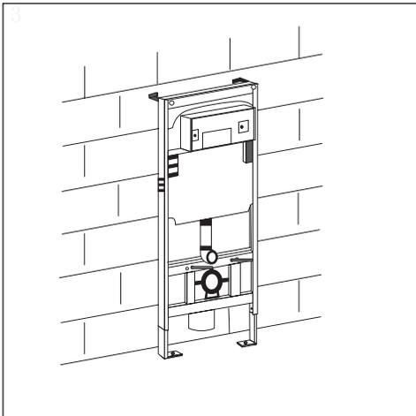
3. Возведите финишную стену, руководствуясь допусками завода изготовителя инсталляции. Толщина стены от 10,5 до 33 мм
