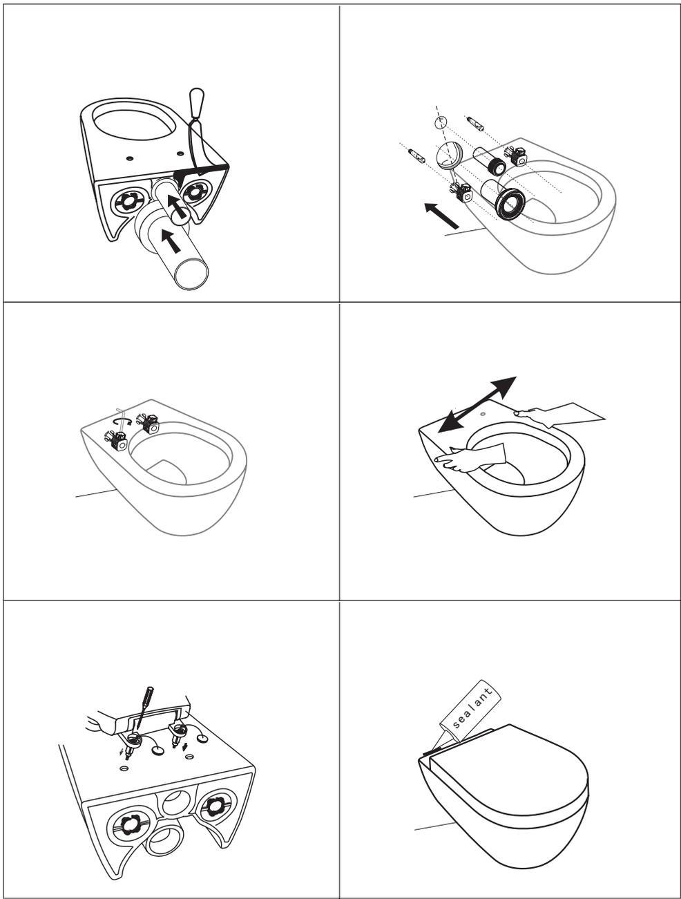
1. Установите подводный трубопровод и канализацию в соответствии с инструкцией производителя Инсталляции.
