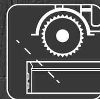
Произвести запил при помощи торцовочной пилы быстрым рубящим движением. Пильный диск должен иметь максимальное количество зубьев (диск для резки алюминия). Выставить необходимый угол и произвести запил.
