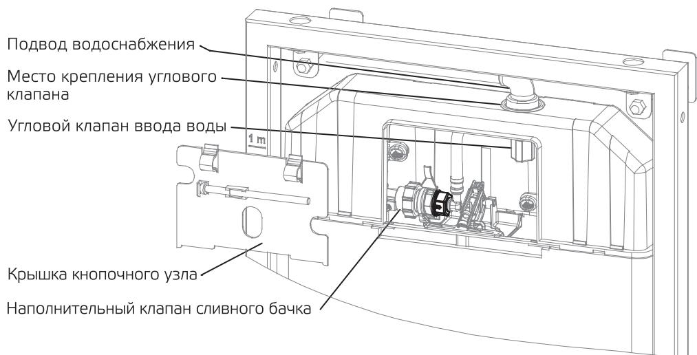
6. После выполнения всех этапов установки инсталляция теперь закреплена к стене и соединена с основной системой водоснабжения и канализации. Чтобы предотвратить проблемы загрязнения во время процесса цементирования или укладки плитки установите на время монтажа: заглушку впускной трубы, заглушку смыивной трубы, защиту шпилек и защитный кожух кнопочного узла.
