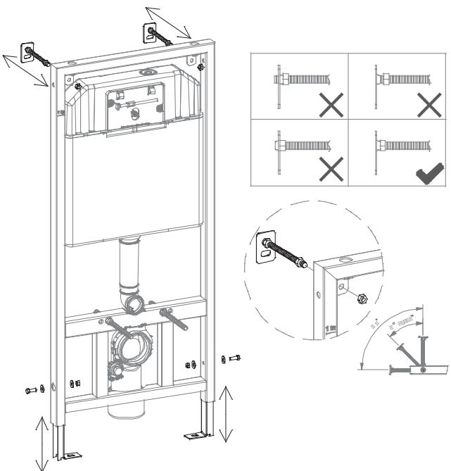
3. Поместите инсталляцию на стену, к которой Вы ее смонтируете. Отметьте стену по корректным точкам крепления к стене и полу. Просверлите отмеченные точки на стене сверлом Ø10 мм. Требуется по крайней мере 70 мм глубиной. Примечание: Проверьте уровнем прямоту установки скрытой системы перед затягиванием гаек.
