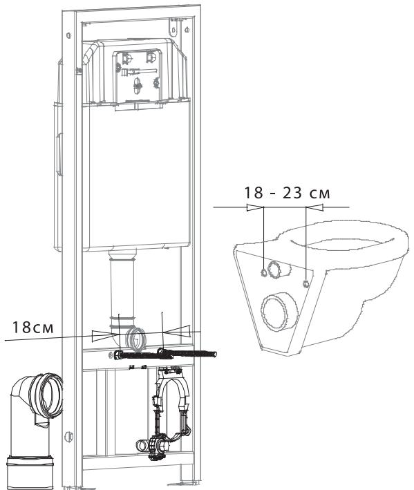
2. Учитывая толщину напольной плитки, определите высоту, на которую вы закрепите унитаз. После этого установите высоту несущих регулируемых ножек рамы. Определите расстояние между стеной и бачком. Затем отрегулируйте и зафиксируйте стенные соединительные части, как показано выше.
