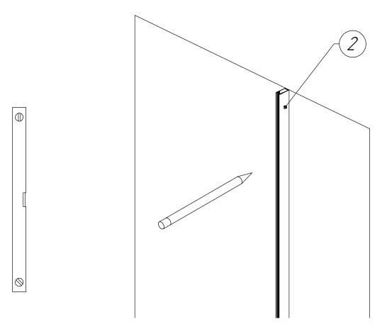
2. Вставьте стекло в профиль ближе к внешней стороне профиля. Ни в коем случае не забивайте стекло по торцевой части, стекло подвержено при таких ударах к разрушению! Вставьте с внутренней стороны профиля уплотнитель елочка. Прижмите уплотнитель ровномерно по всей плоскости профиля.
