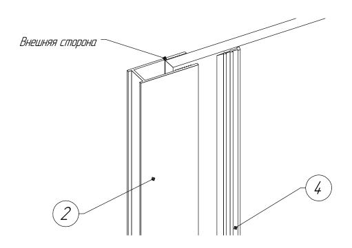
**3.** Примерьте держатель (10) к стеклу (1). Отчертите на стене, места крепления. Установите держатель и затяните фиксатор крепления стекла.
