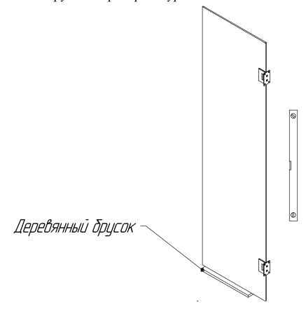
8. Удерживая дверь на месте, отметьте отверстия для обеех петель (16). Просверлите сверлом, вставьте пластиковый дюбель (18) и закрепите при помощи винтов (19) к стене.
