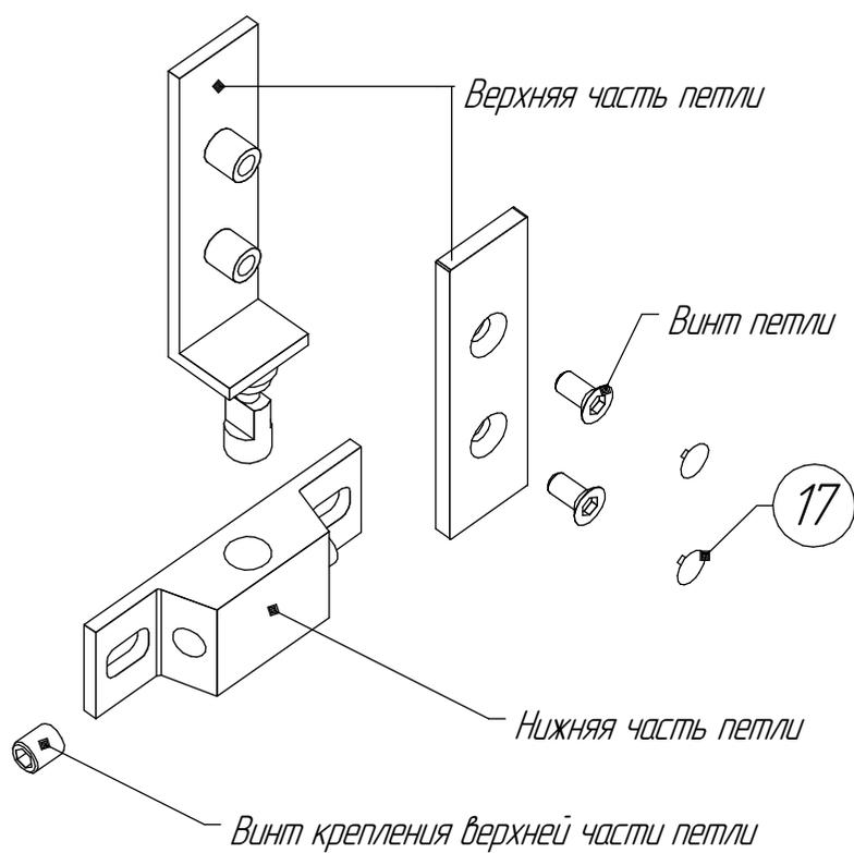
7. Установите на нижнюю трапецию(4) только нижнюю часть петли при помощи винтов (14).
