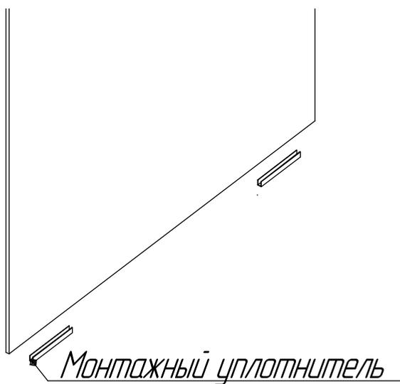
4. Вставьте боковое(2) стекло в паз пристенного профиля(3) и при помощи шайб(11) и винтов(13) закрепите стекло к трапеции(4). Проведите аналогичные действия со вторым боковым стеклом.
