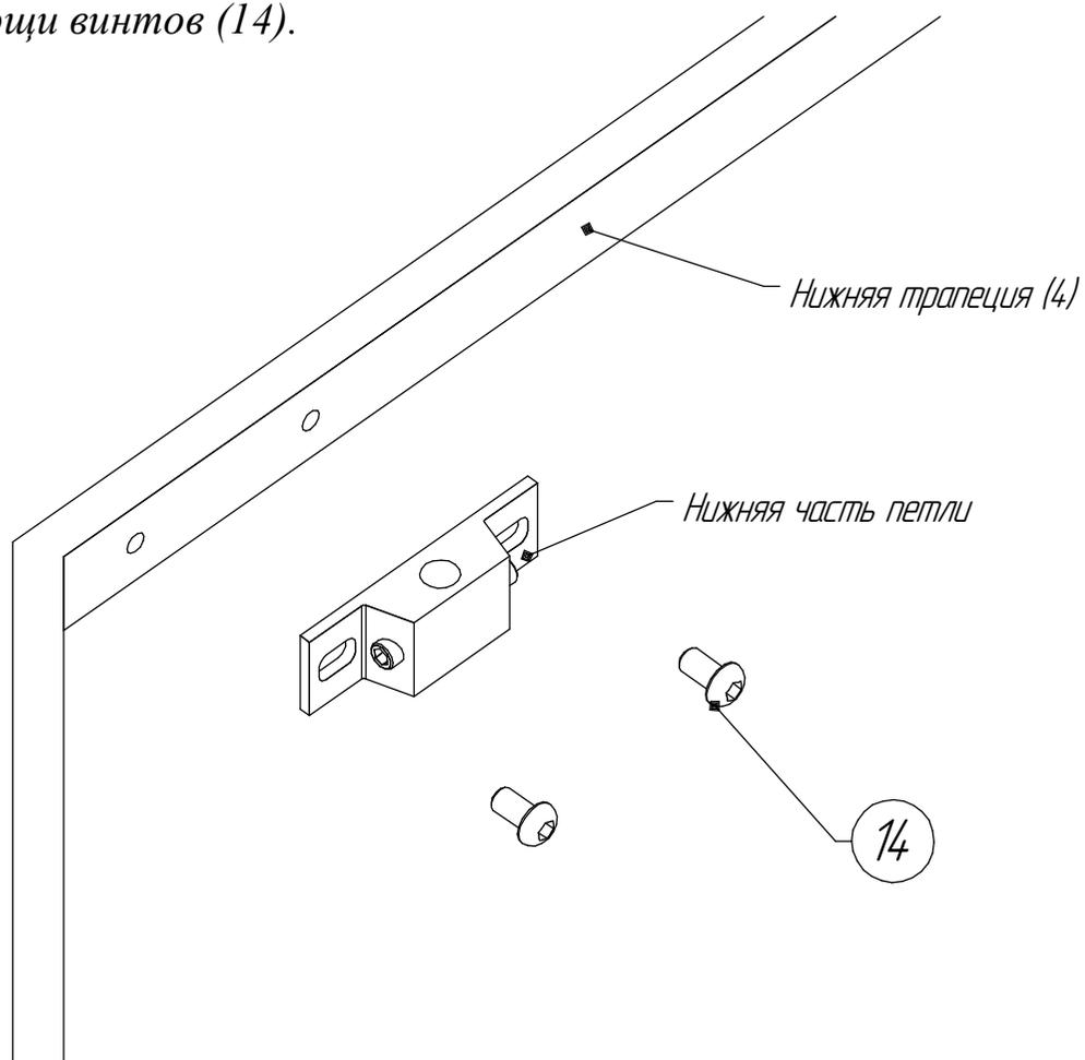
8. Установите на верх стекла дверцы (1) петлю целиком в сборе (5). Установите на низ стекла дверцы верхнюю часть петли. Вставьте дверцу сначала в нижнюю петлю и после этого закрепите верхнюю петлю при помощи винтов (14) к верхней трапеции (4).
