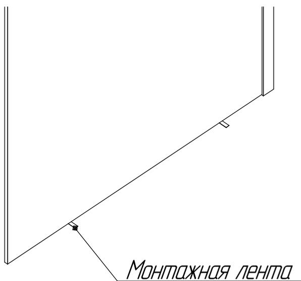
б) Оденьте на низ стекла (2) монтажный уплотнитель. После окончательной сборки изделия, не извлекая уплотнитель, нанесите герметик.
