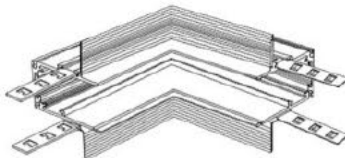
Внутренний угловой соединитель. №3 на схеме №3
