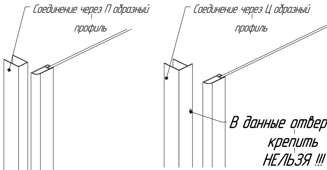
**Обратите внимание! Что крепление через Ц образный профиль ни в коем случае нельзя через готовые отверстия. При закреплении через данные отверстия вы рискуете повредить стекло перегородки. Именно поэтому необходимо просверлить новые отверстия внутри профиля.**
