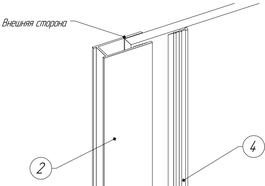
3. Соедините данную перегородку через соединительный профиль (3) при помощи винтов (6). Для винтов (6) необходимо сделать отверстия в обеих профилях диаметром 3 мм.
