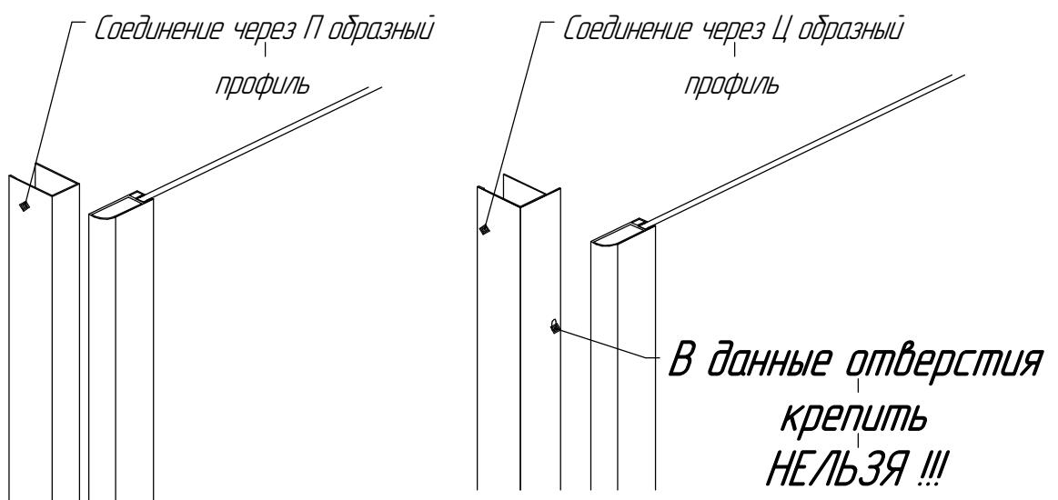
**Обратите внимание! Что крепление через Ц образный профиль ни в коем случае нельзя через готовые отверстия. При закреплении через данные отверстия вы рискуете повредить стекло перегородки. Именно поэтому необходимо просверлить новые отверстия внутри профиля.**
